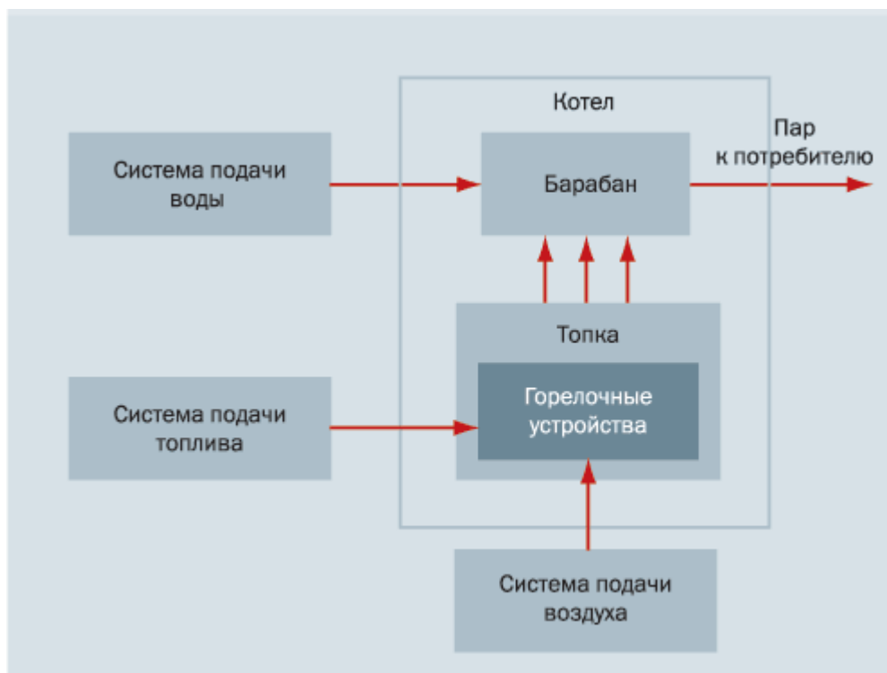
Рисунок 6.1 – Функциональная схема котельного агрегата.
