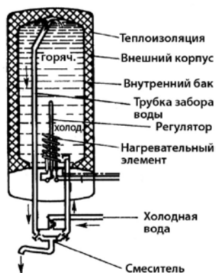
Рис. 10.5. Схема накопительного водоподогревателя [8]
