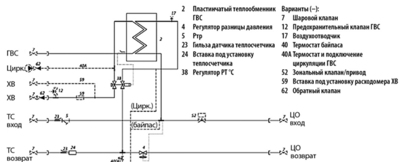
Рис. 10.12. Схема КТП для отопления и горячего водоснабжения [10]
