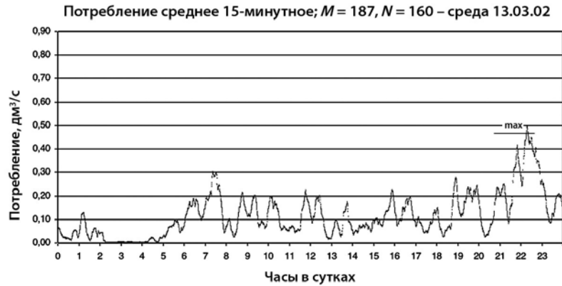
Рис. 2.4. 15-минутная динамика потребления в рабочий день – среду. Горизонтальной прерывистой линией обозначено потребление максимальное 15-минутное \dot{V}_{15\text{min}}^{\text{max}}
